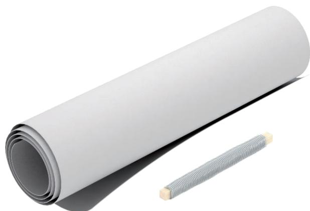
Die Brandschutzbandage wird als Kabelabschottung für Einzelkabel, Kabel- und Elektroinstallationsrohrbündel (EIR) verwendet. Die Abschottung besteht aus einer flexiblen Bandage, welche mittels Draht fixiert wird. Bei der Umhüllung der Kabel ist darauf zu achten, wie oft das jeweilige Medium umwickelt werden muss, Details sind der Zulassung zu entnehmen. Die Bandage kann im Nullabstand zu Rohrabschottungen der Firma Rockwool eingesetzt werden. Wickeldraht ist inklusive.
