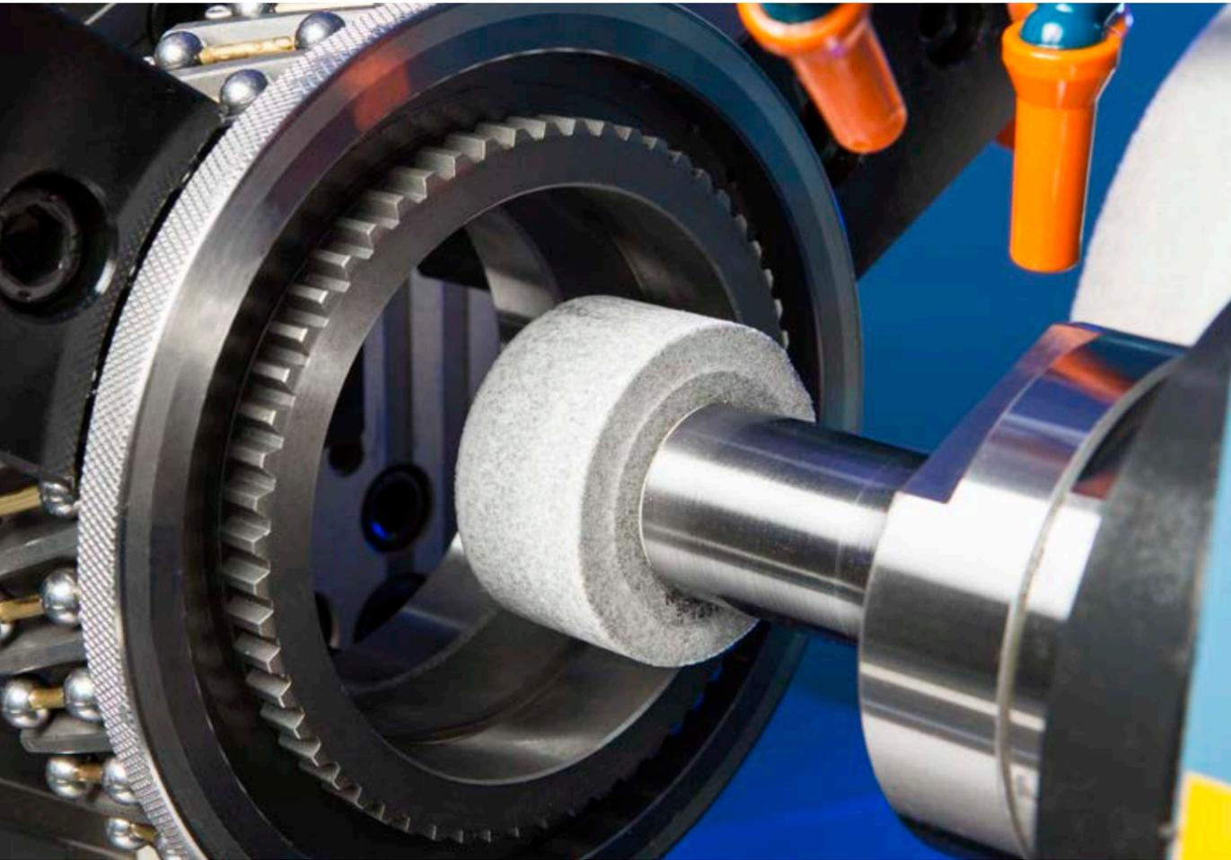
Die vielseitigen Schleifmaschinen der FLEXA Serie sind prädestiniert für die flexible Bearbeitung unterschiedlicher Schleifaufgaben an einem Werkstück. Die FLEXA löst höchstpräzise bis zu drei Schleifaufgaben mit geringer Umrüstzeit. Ob Innen-, Außenbearbeitung und sogar Gewindeschleifen, durch ihre modulare Bauweise ist diese konventionelle und robuste Schleifmaschine optimal für die Klein- und Mittelserienproduktion.
