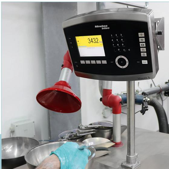
Die exakte Verwiegung von Pigmenten und Additiven erfolgt über die Tischwaage. Eine Absauganlage sorgt für die staubfreie Anwendung
