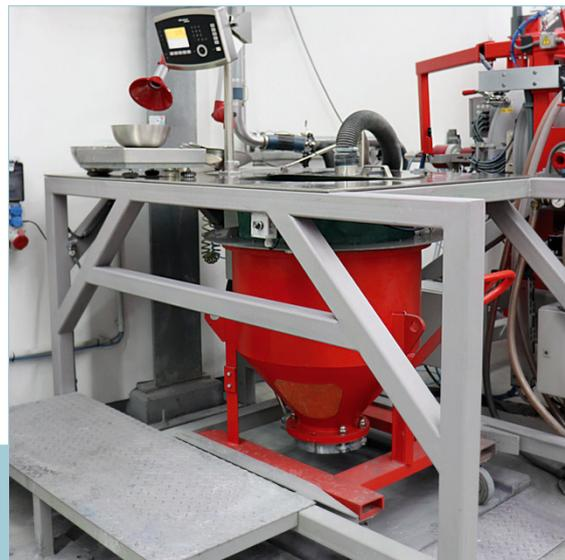
Mischbehälter können auf die IF Bodenwaagen mühelos aufgeschoben werden. Der Wägecontroller verarbeitet die Messergebnisse beider Wägepunkte und führt durch den Rezepturprozess
